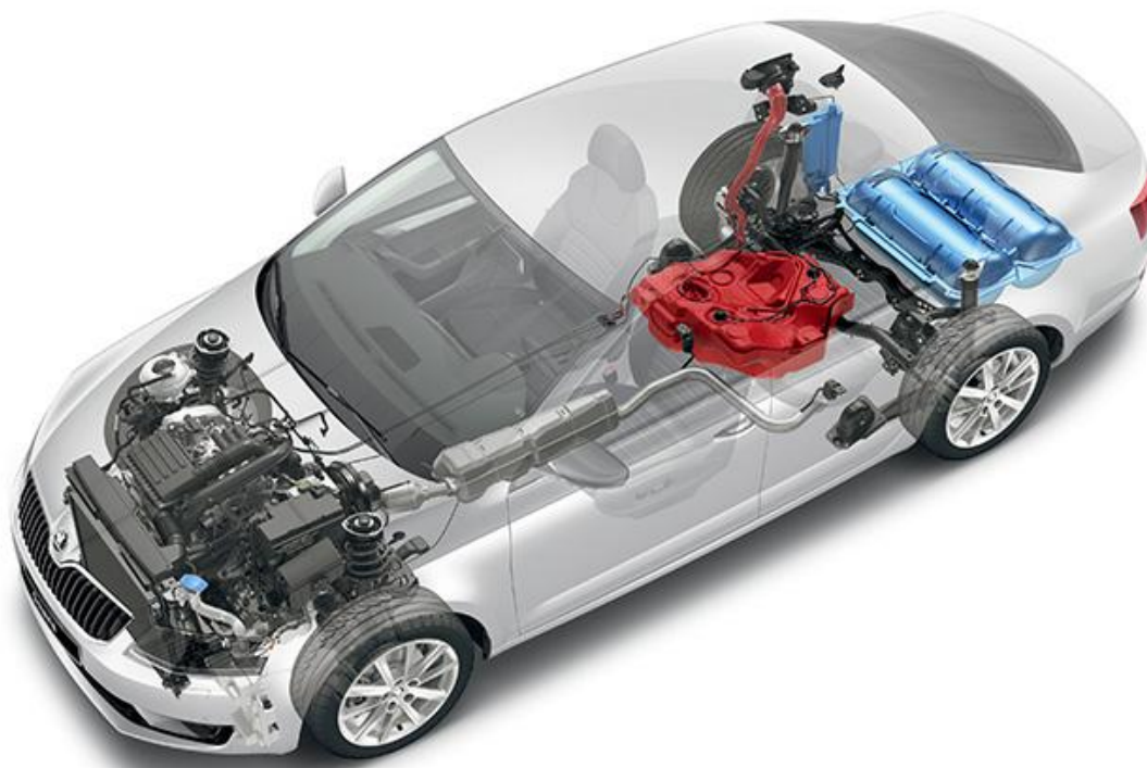
Obr. 4-1 Schéma zástavby vyráběného automobilu na CNG
