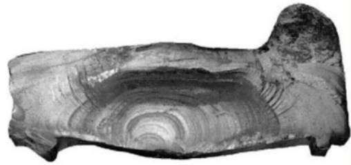
Obrázek 3: (a) Nehoda vlaku ICE. (b) Lomová plocha vnějšího věnce kola.
