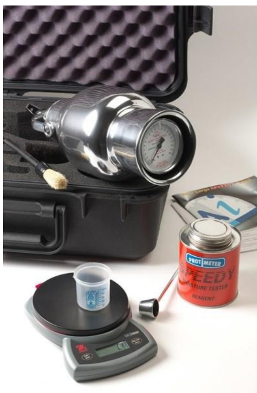
Obr. 3.5 Souprava pro měření vlhkosti karbidovou metodou URL č.1
