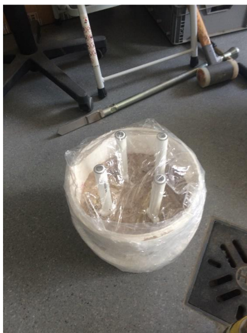
Obr 5.3 Nádoba naplněna minerální půdou osazena senzory a zakryta fólií (foto autor)
