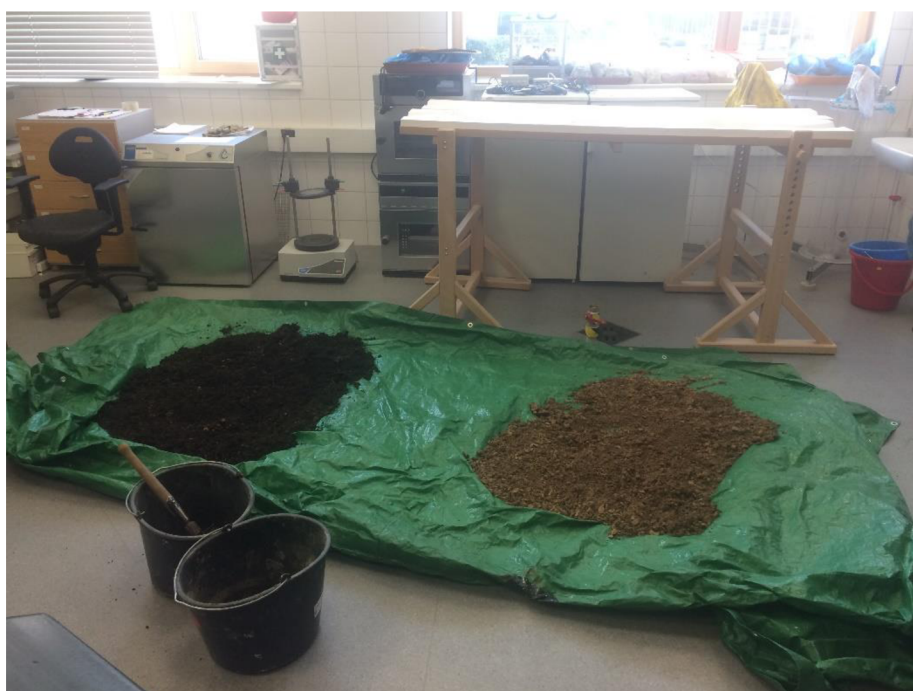
Obr 5.2 Sušení organické (vlevo) a minerální (vpravo) půdy v laboratoři (foto autor)
