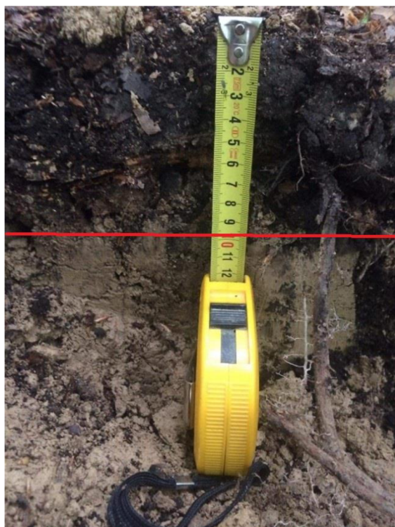
Obr. 4.5 Mocnost organické a minerální části půdy (bukový porost, BP I/1) na lokalitě Amálie, kde červená přímká zvýrazňuje přechod mezi organickou a minerální částí půdy (foto autor)
