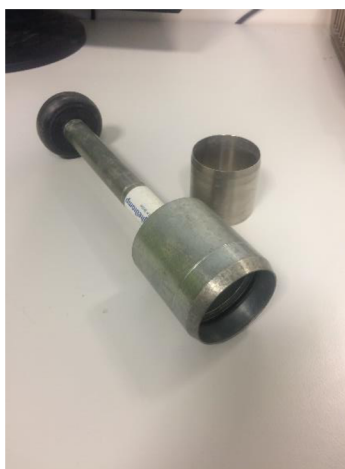
Obr 5.1 Kopeckého váleček (vzadu) a násada pro provádění odběru (vpředu) (foto autor)
