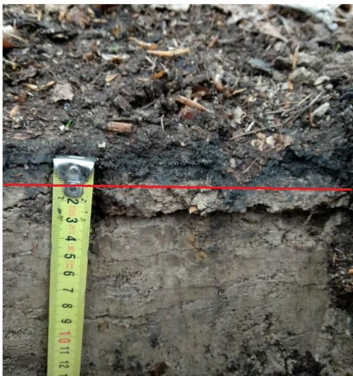
Obr. 4.4 Mocnost organické a minerální části půdy (bukový porost, BP I/1) na lokalitě Amálie, kde červená příčka zvýrazňuje přechod mezi organickou a minerální částí půdy (foto autor)
