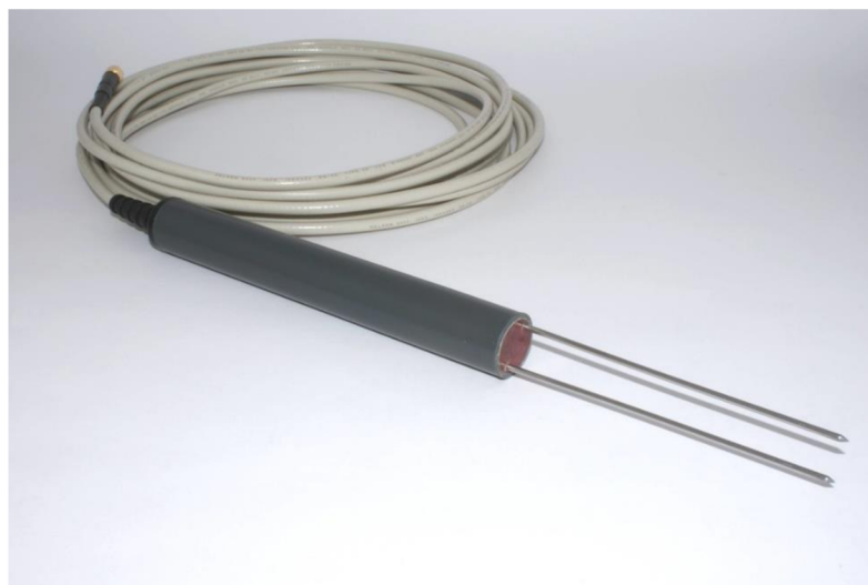
Obr. 3.9 Senzor TDR se dvěma hroty URL č. 2
