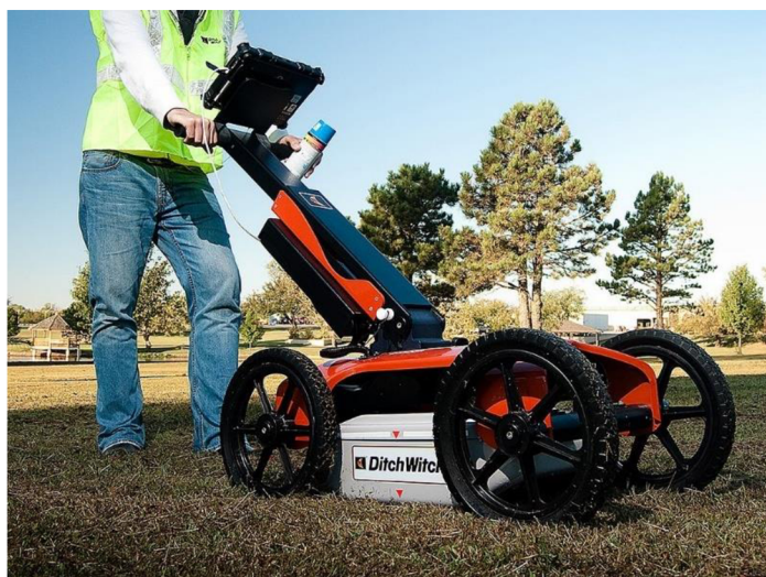
Obr. 3.15 Použití GDP (ground penetrating radar) URL č. 4
