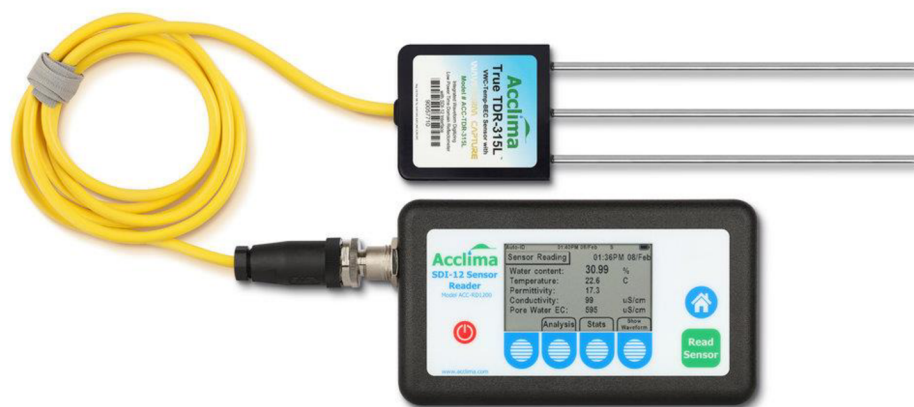
Obr. 3.10 Senzor TDR se třemi hroty URL č. 3
