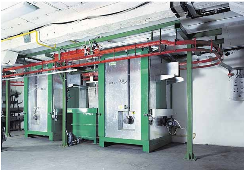
Obr. 3.6.: Linka pro fluidní nanášení práškové barvy [7]
