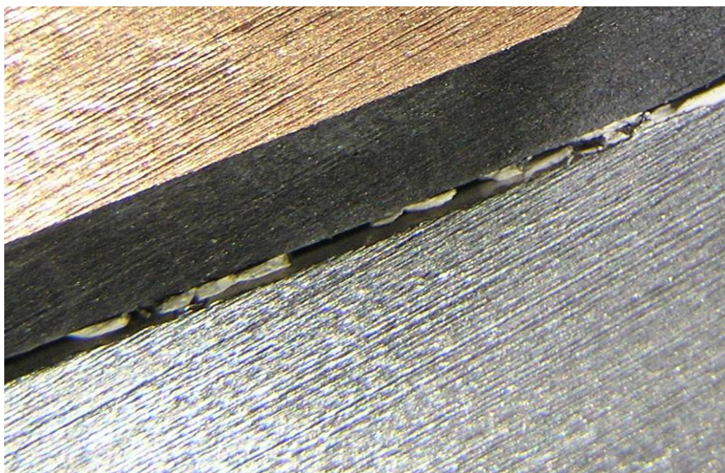
Obr. 5.8: Řez součástky s epoxid barvou BIANCO 9003
