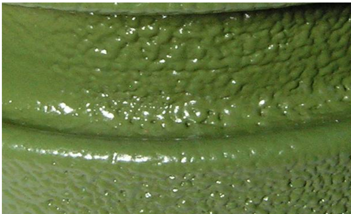
Obr. 5.5: Zadaná součástka po aplikaci barvy 3M s předehřevem na teplotu materiálu 250°C
