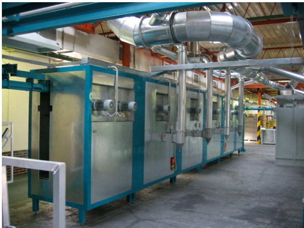
Obr. 3.8.: Vytvrzovací pec průjezdného typu [10]
