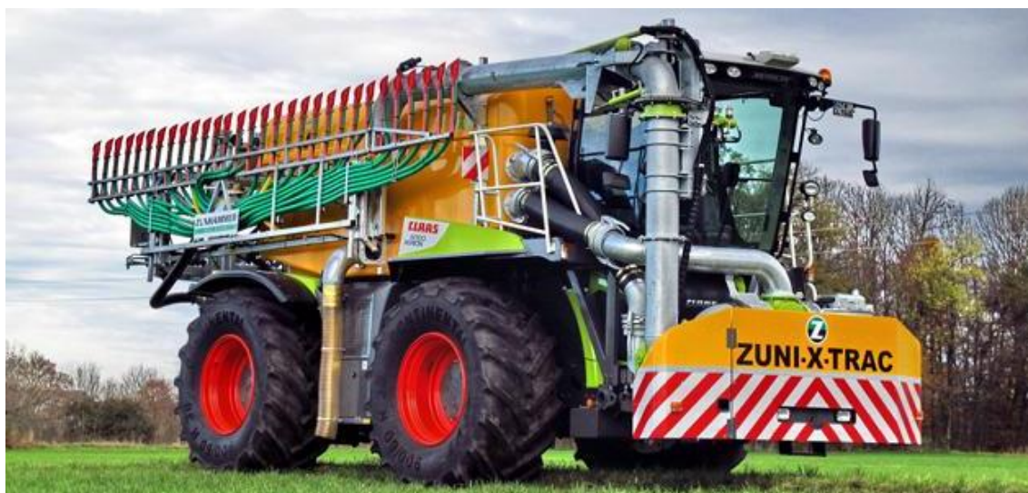
Obrázek 21 Claas Xerion Saddle Trac s nástavbou Zunhammer pro aplikaci kejdy (Zdroj: Zunhammer)
