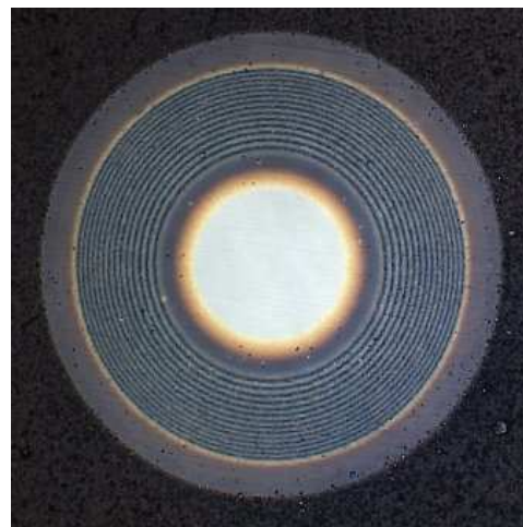
Obr. 3.6 Složení povlaku 4. generace (kalota) [15].
