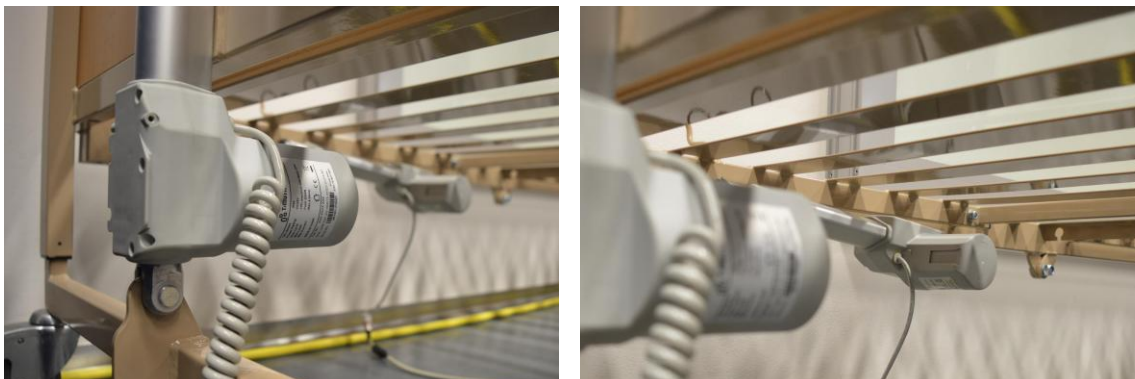
Obrázek 8: Rozmístění lineárních aktuátorů na spodní straně lůžka
