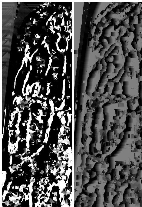
Obrázek 4.13: Disparitní mapy získané pomocí StereoSGBM (vlevo) a StereoBM (vpravo).
