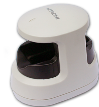
Obrázek 2.3: Zařízení na snímání žil prstu od společnosti Hitachi. 2
