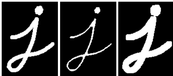
Obrázek 2.5: Ukázky aplikace morfologických transformací 3 . Zleva původní obrázek, eroze a dilatace.
