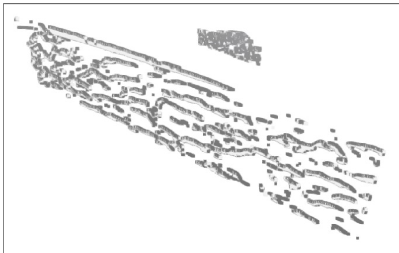
Obrázek 5.3: Pohled na celkový získaný model z disparitní mapy získané ze StereoBM.
