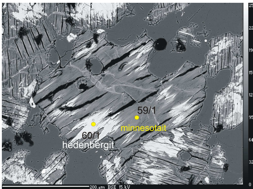
Obr. 32 Přeměna hedenbergitu v minnesotait. Obraz BSE. Čísla odpovídají číslům analýz v tab. 5. Místo analýz k3 dle obr. 26.
