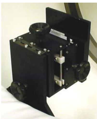
Obr. 10. Příklady QA CT fantomů používaných při měření a držák QA CT fantomu.(9)
