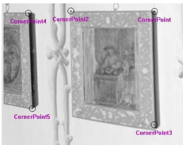
Obr. 2.6: Spojovací bod - jednoznačný bod [3]
