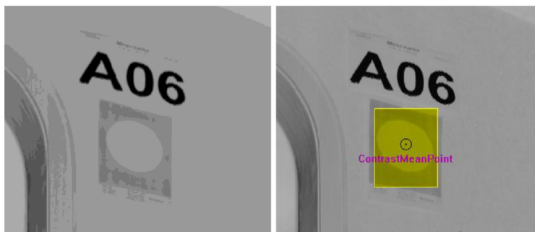
Obr. 2.4: Spojovací bod - kontrastní terč [3]
