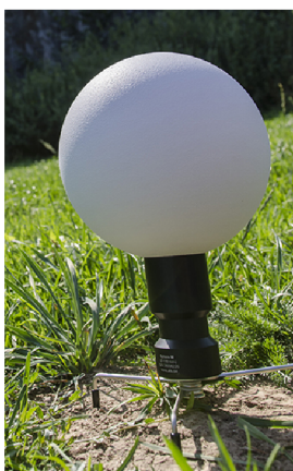
Obr. 2.3: Spojovací bod - koule
