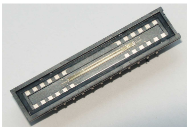
Obr. 2 – Řádkový obrazový CMOS senzor Hamamatsu S10077
