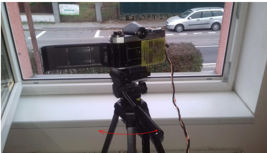
Obr. 21. Pomaloběžná kamera, realizovaná za pomoci fotoaparátu Praktica, řádkového snímače a ručního pohonu v horizontální ose.
