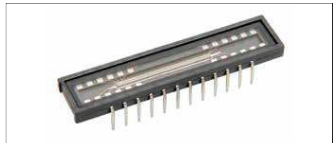
Obr. 2 Řádkový obrazový CMOS senzor Hamamatsu S10077
