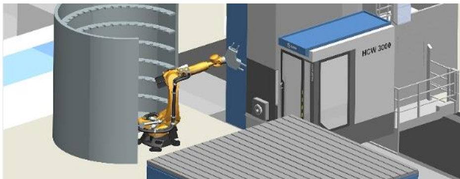
Obr. 6 Statický cylindrický zásobník a výměnou nástrojů pomocí robotu [2]
