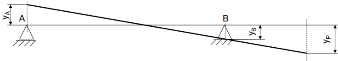
Obr. 38 Průhyb vřetene za předpokladu, že ložiska jsou poddajná a vřeteno tuhé [20]
