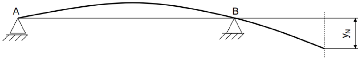
Obr. 37 Průhyb vřetene zatíženého silou F za předpokladu, že ložiska jsou tuhá [20]
