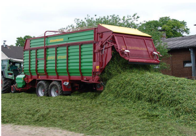
Obrázek 3 Sběrací vůz s možností pořezu Strautmann [6]
