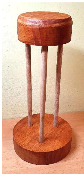
Obrázek 5.23. – sestavená vnější kostra Voltova sloupu
