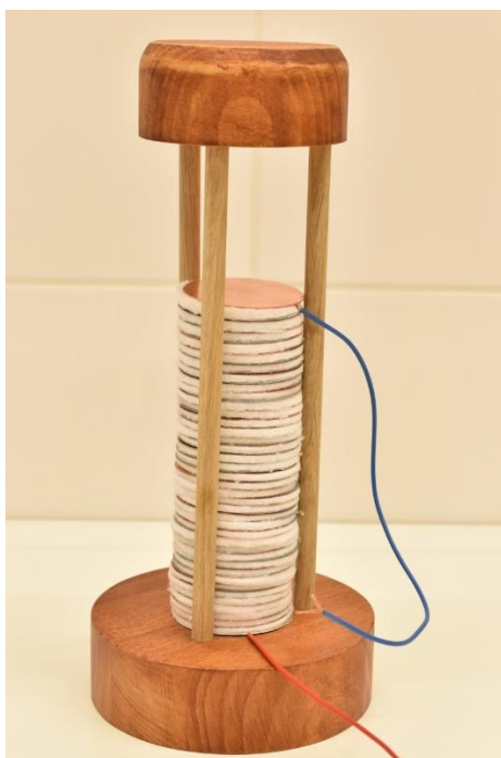
Obrázek 3.9. – replika Voltova sloupu
