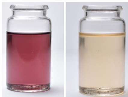
Obrázek 5.25. – čerstvý roztok elektrolyticky připraveného železnanu draselného ( K_2FeO_4 ) (vlevo) a stejný roztok po samovolném rozkladu (vpravo)
