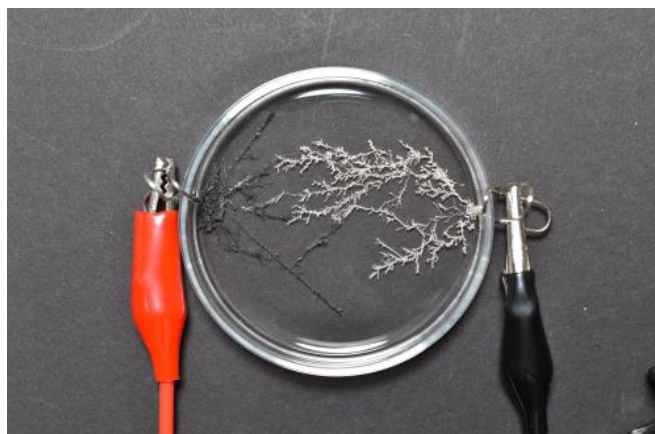
Obrázek 5.30. – finální výsledek pokusu po ukončení elektrolýzy dusičnanu stříbrného ( \text{AgNO}_3 ) (vpravo katoda s vyredukovaným stříbrem a vlevo anoda s vyloučenou neznámou látkou)
