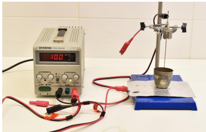
Obrázek 5.24. – sestavená a zapojená aparatura pro pokus o izolaci draslíku / sodíku dle Humphry Davyho
