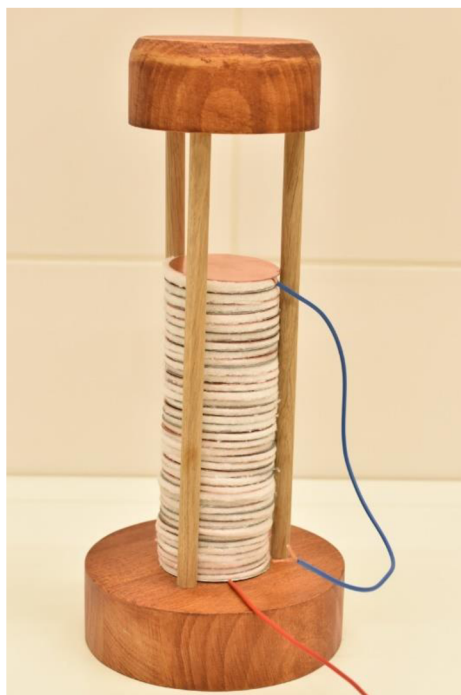
Obrázek 3.9. – replika Voltova sloupu
