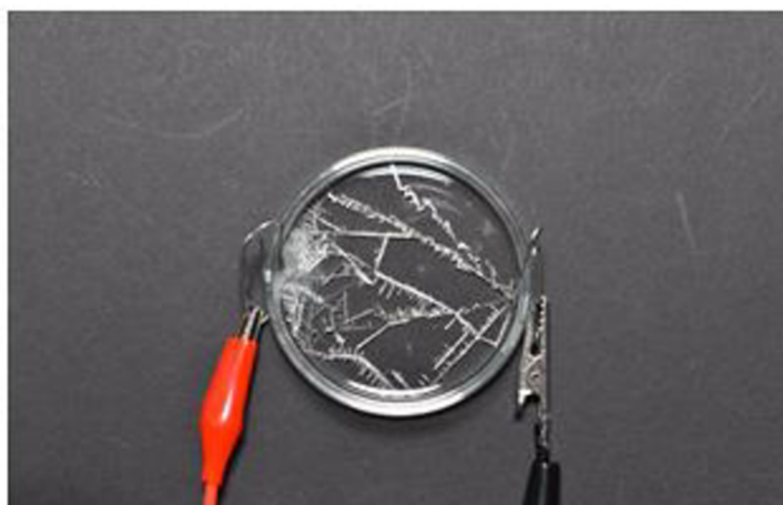
Obrázek 5.32 – finální výsledek pokusu po ukončení elektrolyzy dihydrátu chloridu cínatého ( \text{SnCl}_2 \cdot 2 \text{H}_2\text{O} ), kde černý vodič (vpravo) představuje katodu s vyloučeným cínem v podobě stříbrných jehlicovitých krystalů
