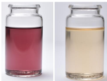
Obrázek 5.25. – čerstvý roztok elektrolyticky připraveného železnanu draselného ( \text{K}_2\text{FeO}_4 ) (vlevo) a stejný roztok po samovolném rozkladu (vpravo)
