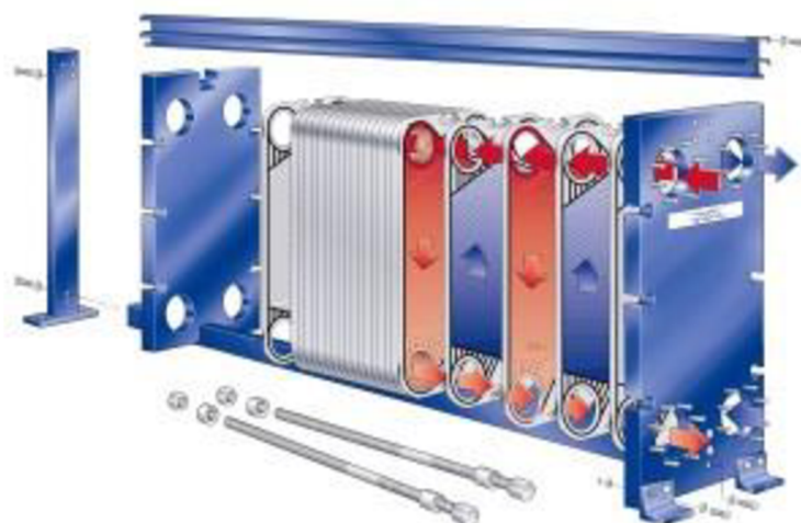
Obr. 1-8 Schéma deskového výměníku [7].
