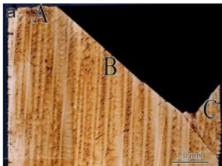
Obr. 26 Lomová plocha slitiny TMS-75 [18]
