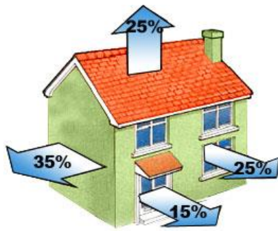
Obr. 4 Obálka budovy - tepelné ztráty obalovými konstrukcemi [10]
