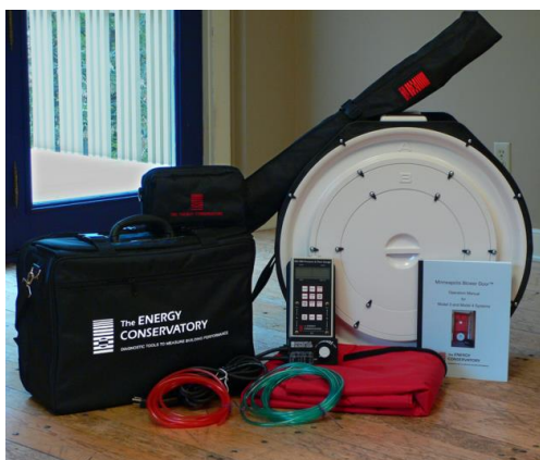
Obr. 35 Základní balení prvků Blower-door testu [24]
