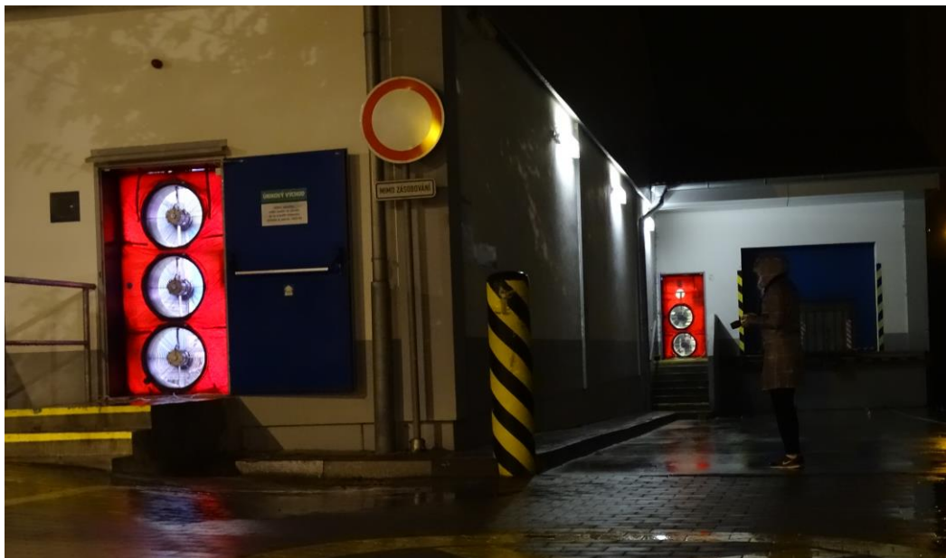
Obr. 33 Pohled na umístěné ventilátory za provozu Blower-door testu z exteriéru
