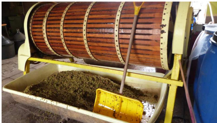
Foto 3: Lisování hroznů vinné révy v horizontálním lisu
