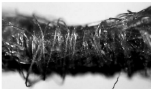
Obrázek č.9 Rotorová příze[15]
