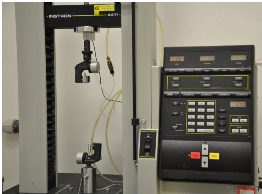
Obrázek č. 7 Instron 4411 měření pevnosti a tažnosti [30]
