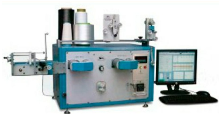
Obrázek č. 20 CTT (Constant Tension Transport) []
