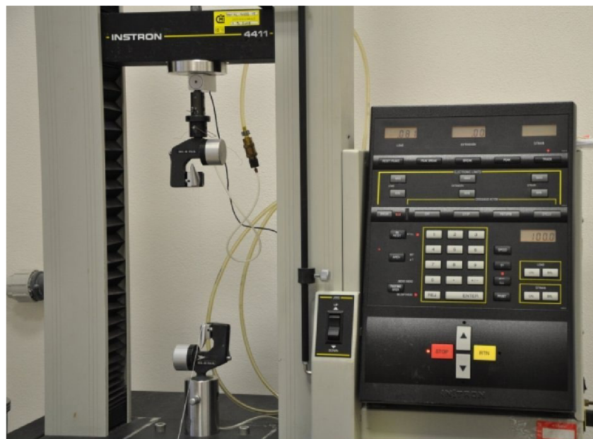
Obrázek č. 7 Instron 4411 měření pevnosti a tažnosti [30]
