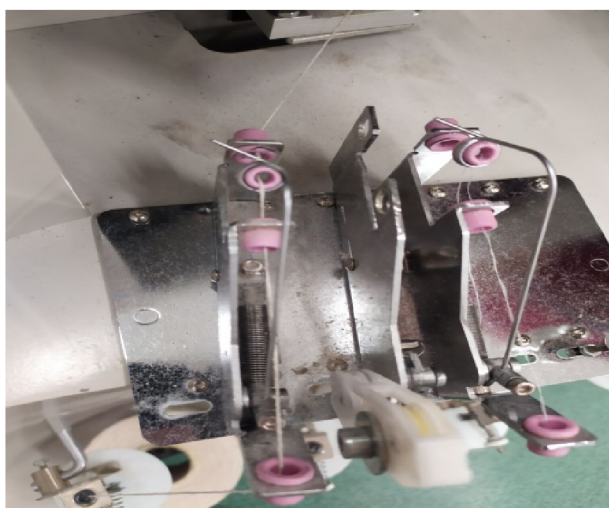
Obrázek č.14 Útkový podáváč na tkalcovském stoji podává nit do vodicích oček (100% CO) [31a]
