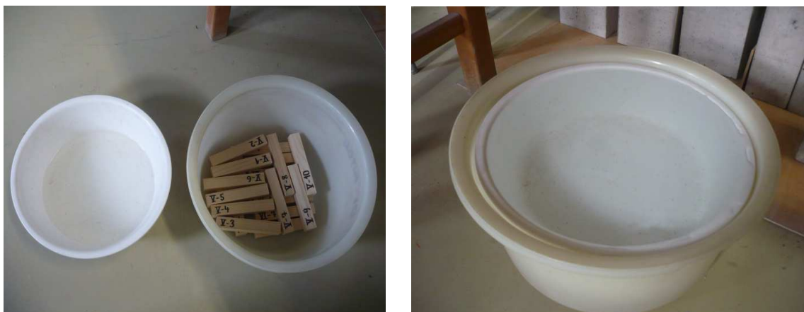
Obr. 14: Fotodokumentace vlhčení zkušebních vzorků
