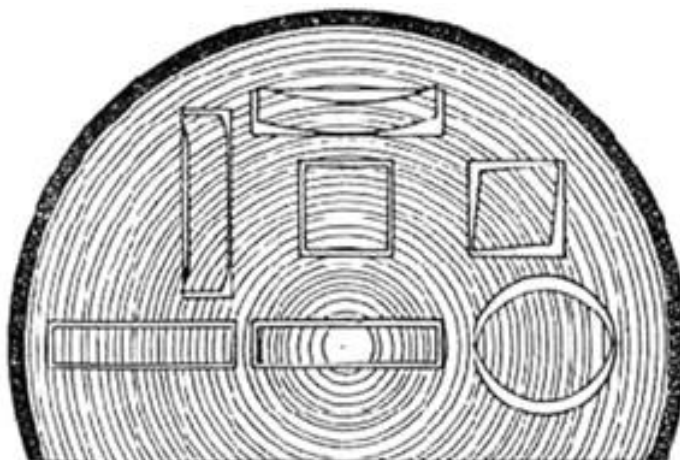
Obr. 6: Druhy příčného borcení dřeva [17]
