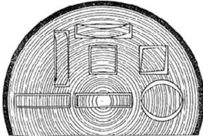
Obr. 6: Druhy příčného borcení dřeva [17]
