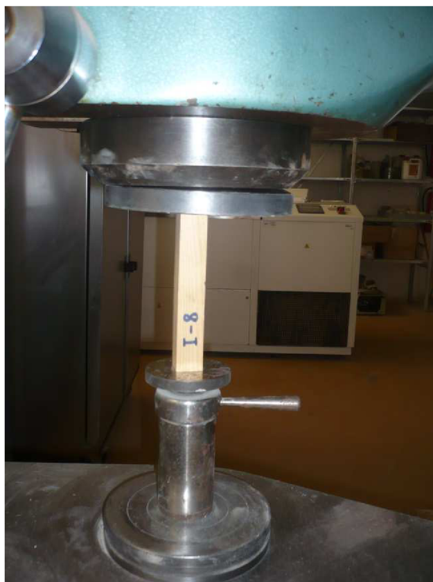
Obr. 15: Fotodokumentace a schéma zkoušky pevnosti v tlaku rovnoběžně s vlákny
