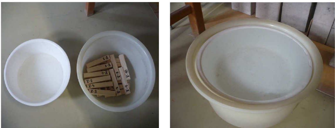
Obr. 14: Fotodokumentace vlhčení zkušebních vzorků
