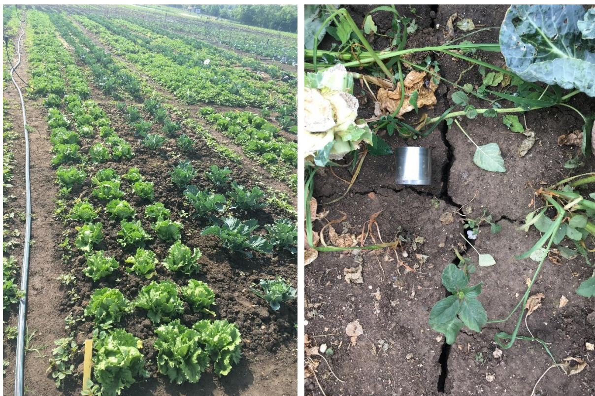
Obrázek 7: Fotografie parcel ze dne 08.06.2022 – vlevo, fotografie trhliny v zhutněné půdě v porovnání s Kopeckého válečkem o objemu 100 cm 3 ze dne 12.07.2022 – vpravo (z archivu autora).
