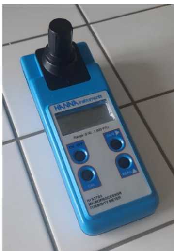
Obrázek č. 5. Mikroprocesorový měřič zákalu značky HANNA Instruments typ HI 93703
