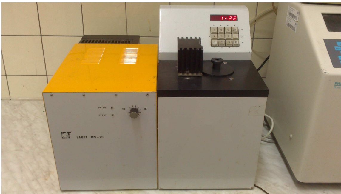
Obrázek č. 1: Kalorimetr MS 10A, německé firmy LAGET (autorka, 2013)
