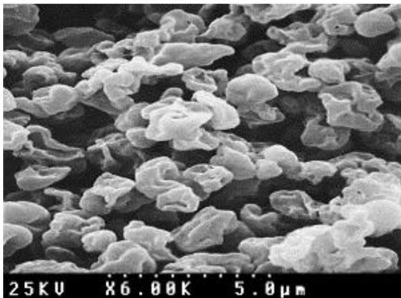
Obr. 27: SEM zobrazení usušených liposomů SOD\DPPC\sacharóza [33]
