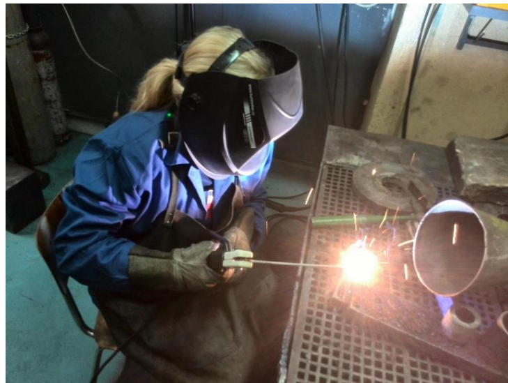
Obrázek č. 7 - svařování elektrickým obloukem – autor práce
