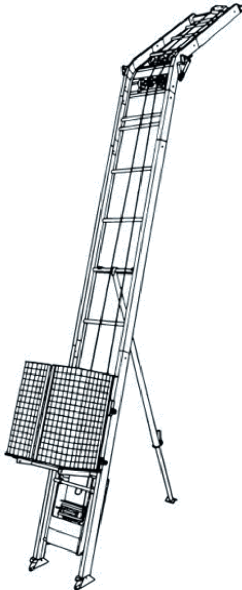
Obr. 3.1 Šikmý střešní lanový výtah
