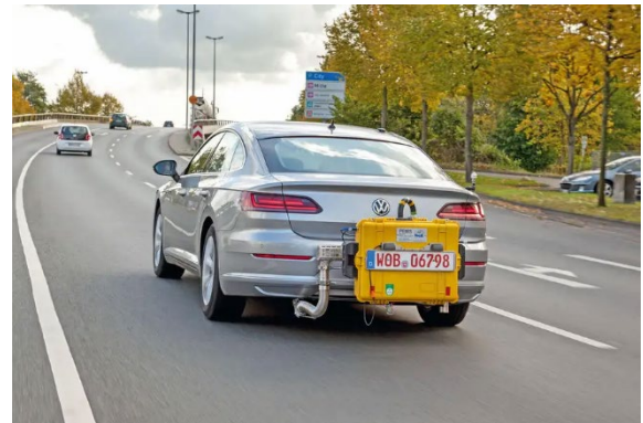
Obr. 2 RDE - test vozidla v reálném prostředí pomocí zařízení PEMS
