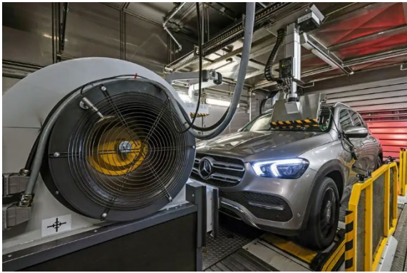
Obr. 1 Test vozidla na válcové zkušebně
