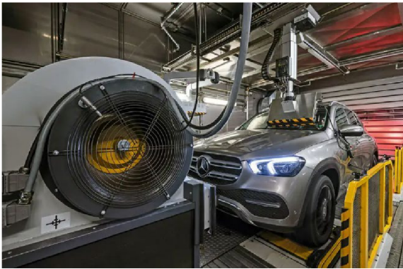
Obr. 1 Test vozidla na válcové zkušebně
