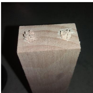
Obrázek 31 Porušení spoje v kolíku (lub).
