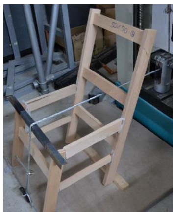
Obrázek 42 Zatěžovací zkouška židle (Kasal et al., 2016b).
