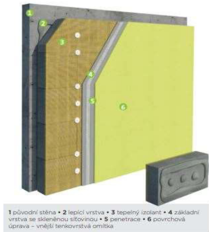
Obr. 5 Kontaktní zateplení
