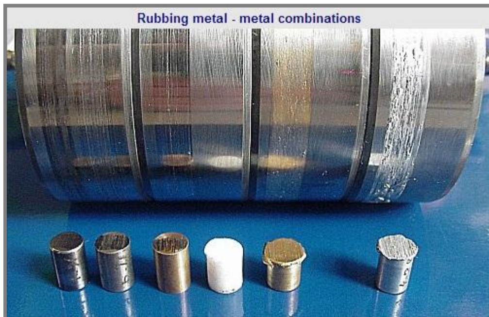
Obr. 4 Adhezivní opotřebení různých materiálů při absenci maziva (z leva- legovaná ocel, tepelně upravená ocel, bronz, teflon, mosaz, hliník) [9].
