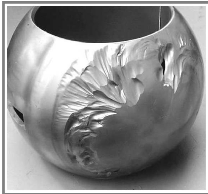
Obr. 6 Erozivní opotřebení koule kulového ventilu [7].
