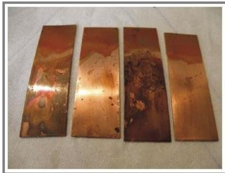
Obr. 9 Koroze způsobená vodou obsaženou v mazacím oleji [14].
