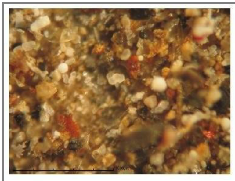
Obr. 12 Mechanický prach v mazacím oleji [14].
