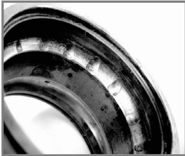
Obr. 8 Vibrační opotřebení valivého ložiska [7].
