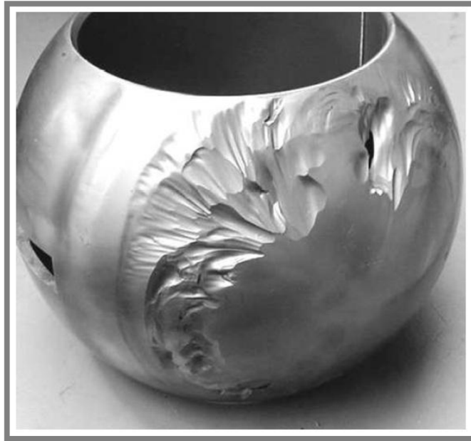
Obr. 6 Erozivní opotřebení koule kulového ventilu [7].
