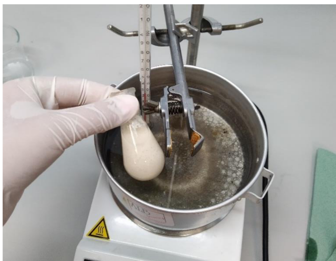
Obrázek 18: Příprava částic PET – po zpětném srážení
