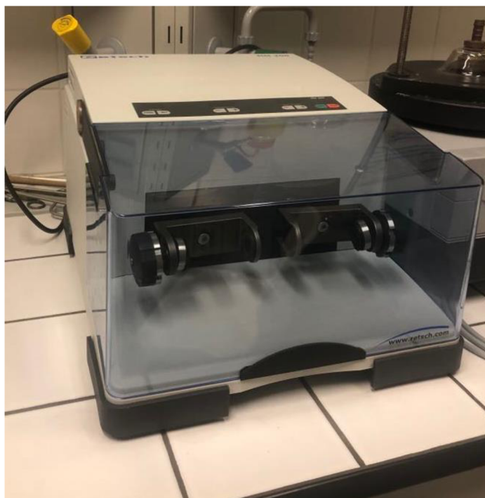
Obrázek 7: Oscilační mlýn Retsch MM 200
