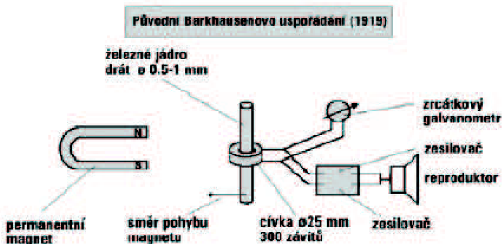
Obr. č. 7: Původní Barkhausenovo uspořádání zesilovače
