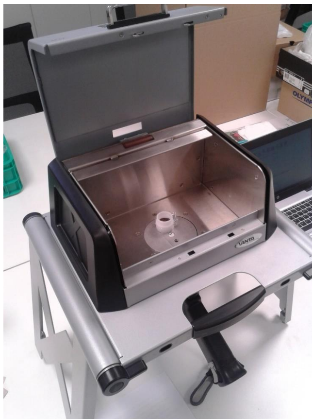
Příloha 13: Detail analyzačního stolku rentgenového přístroje Olympus VANTA XRF s umístěnou navážkou půdy v epruvetě (Foto: Tomáš Černý 2020).
