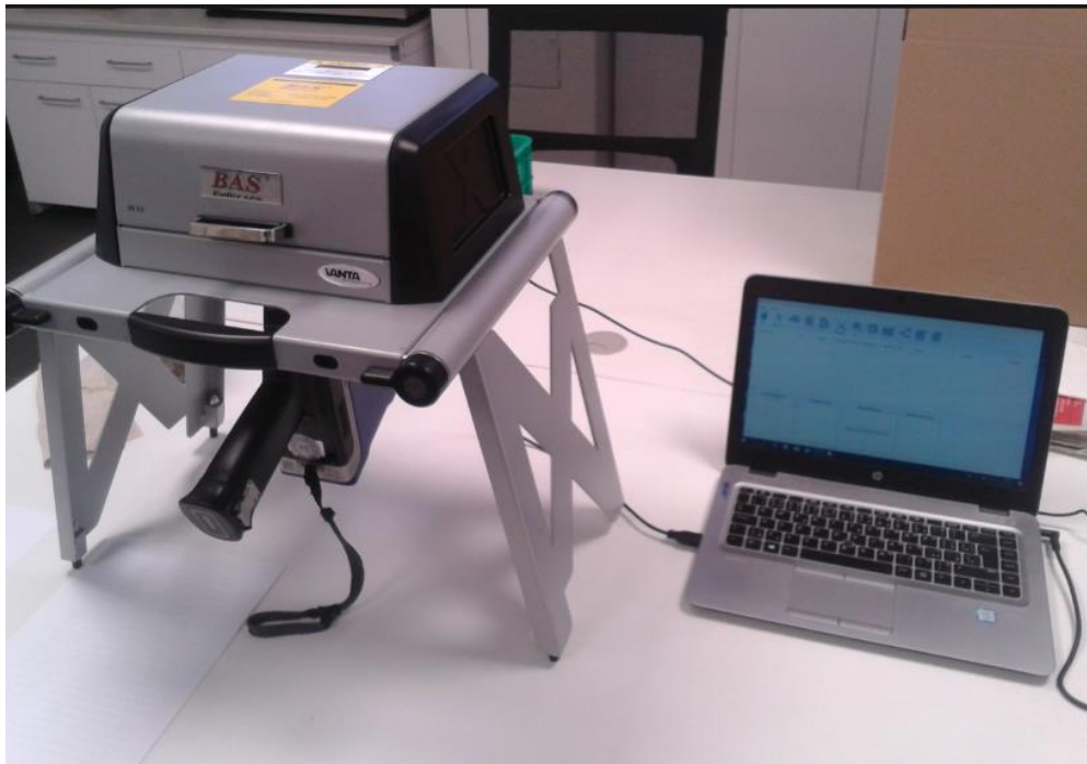
Příloha 12: Rentgenový přístroj Olympus VANTA XRF k měření obsahu prvků v půdě v laboratorním statickém provedení s analyzačním stolem a s připojeným notebookem (Foto: Tomáš Černý 2020).
