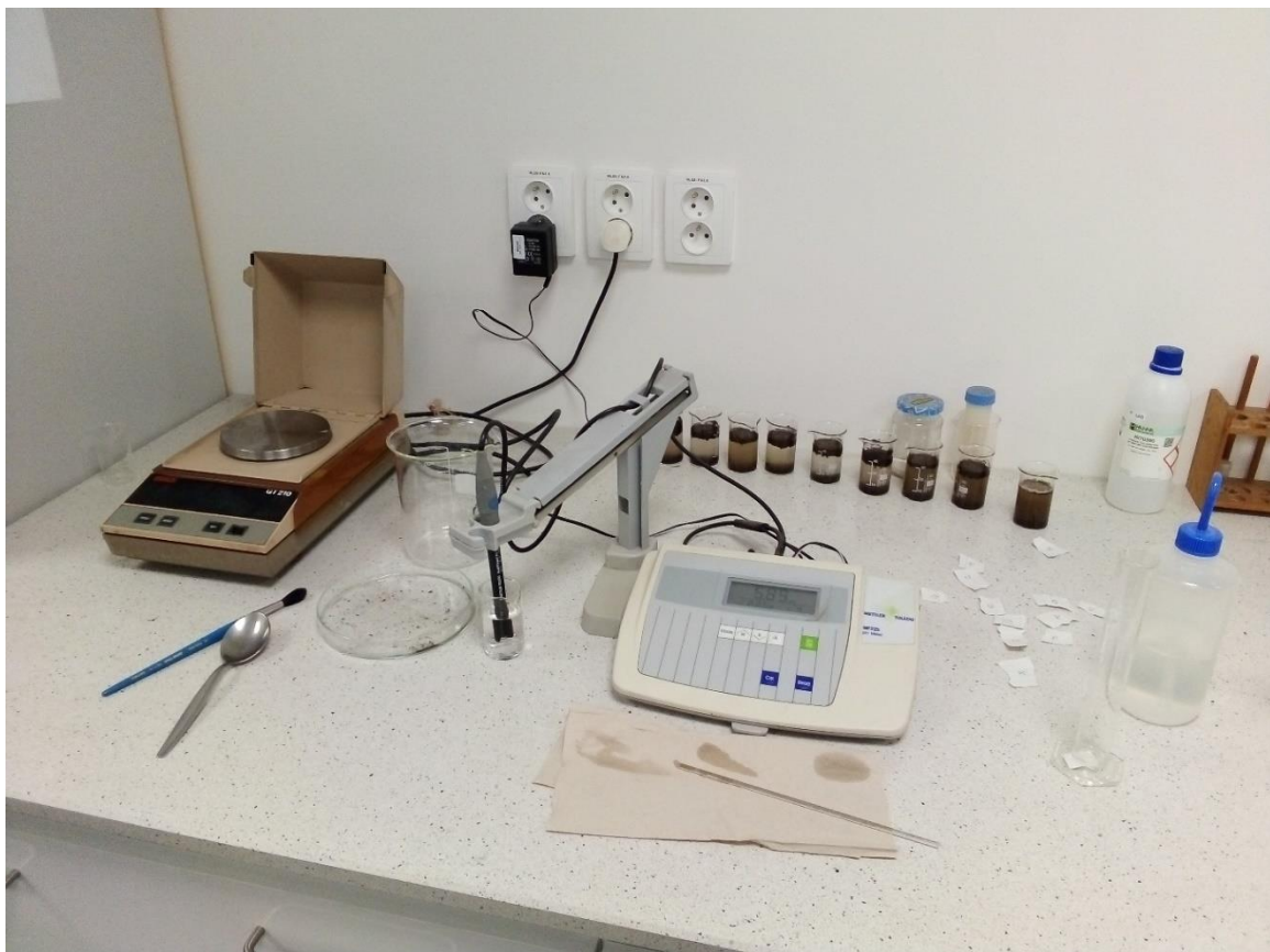
Příloha 11: Měření pH, zleva: váha k měření navážky, kádinka (500 ml) a Petriho miska k čištění elektrody destilovanou vodou, pH metr, v kádinkách v zadní části fotky odstátý roztok navážky půdy a destilované vody (Foto: Tereza Halašková 2019.)
