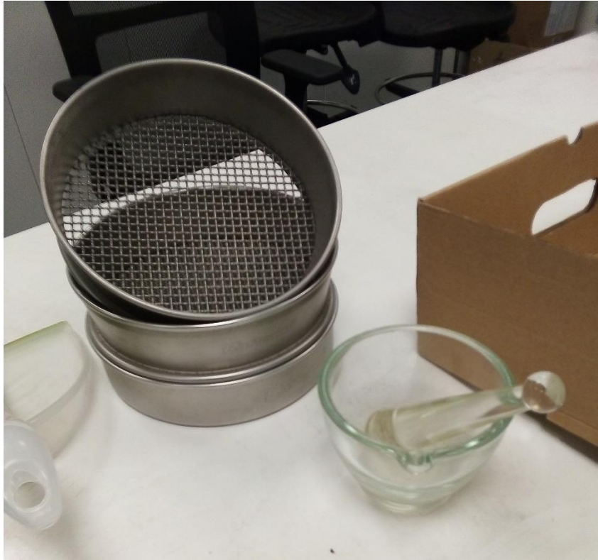
Příloha 10: Kovové síto s dvoumilimetrovými otvory a skleněný hmoždír s tloučkem k úpravě vzorků půdy (Foto: Tereza Halašková 2019.)
