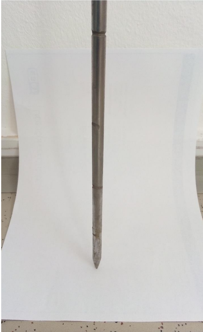
Příloha 9: Detail špičky nerezové kulatiny s vybroušenými značkami s odstupem 5 cm, d=120 cm, \varnothing=8 mm, k měření hloubky půdy (Foto: Tereza Halašková 2019).
