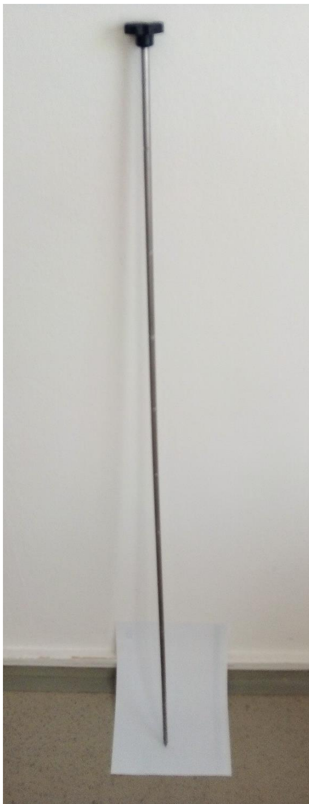
Příloha 8: Nerezová kulatina s vybroušenými značkami s odstupem 5 cm d=120 cm, \text{Ø}=8 mm, k měření hloubky půdy (Foto: Tereza Halašková 2019).
