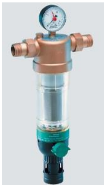
Obrázek 9: Jemný filtr se zpětným proplachem pro montáž do potrubí za čerpadlem (Využívání dešťové vody – kvalita a čištění, 2007)
