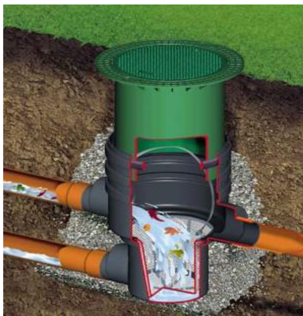
Obrázek 7: Košíčkový filtr (Využívání dešťové vody – kvalita a čištění, 2007)
