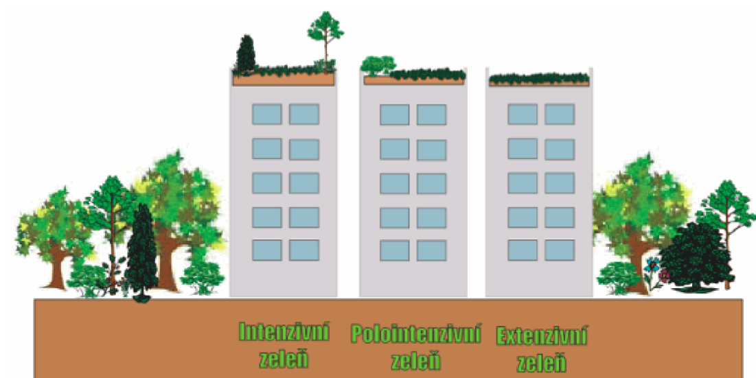
Obrázek 10: Rozdělení střešních zahrad (Retence dešťových vod I., 2009)
