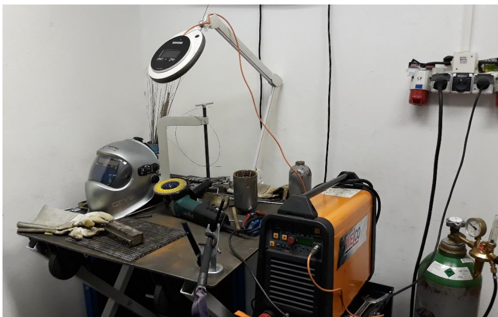
Obr. 42 Pracoviště pro realizaci navařování
