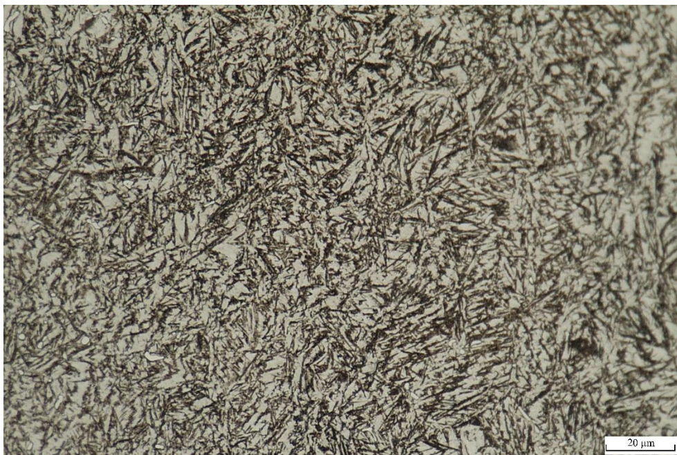
Obr. 58 Mikrostruktura TOO, RC 60, zvětšení 1000x
