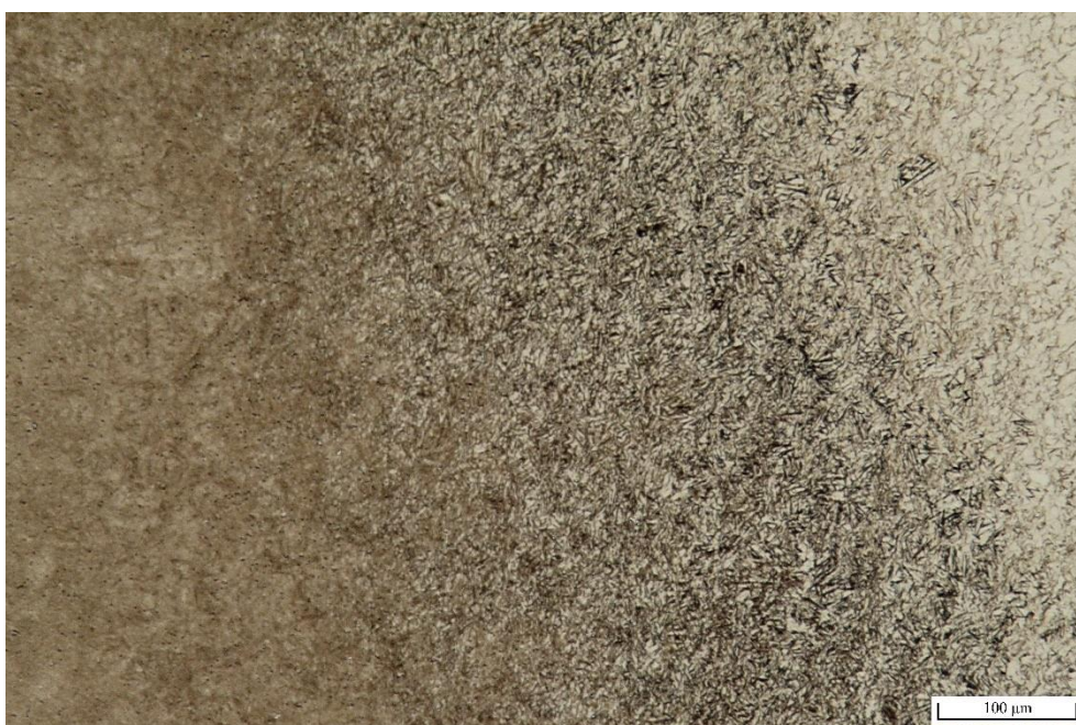
Obr. 59 Mikrostruktura TOO – MEZ, RC 60, zvětšení 250x
