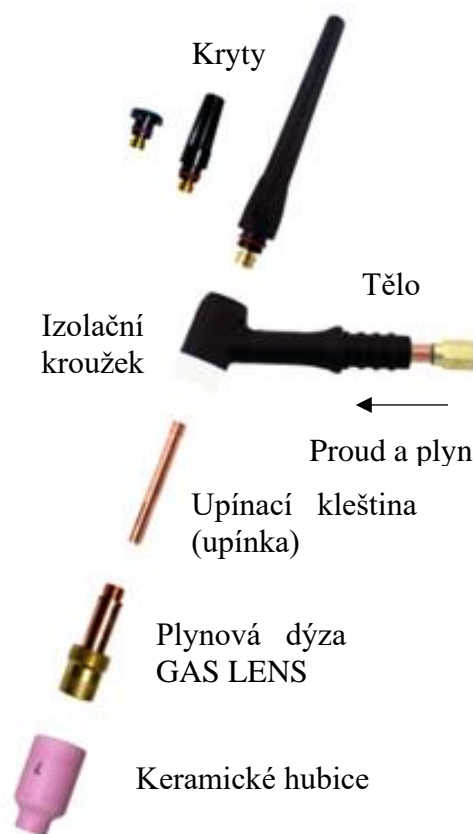
Obr. 21 Navařovací hořák [27]
