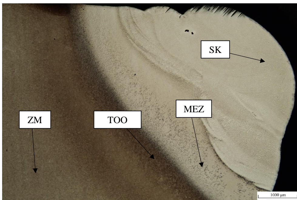
Obr. 56 Znárodnění míst zkoumaných oblastí vzorku RC 60
