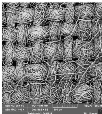
Obrázek 7 SEM snímek struktury bavlněné tkaniny
