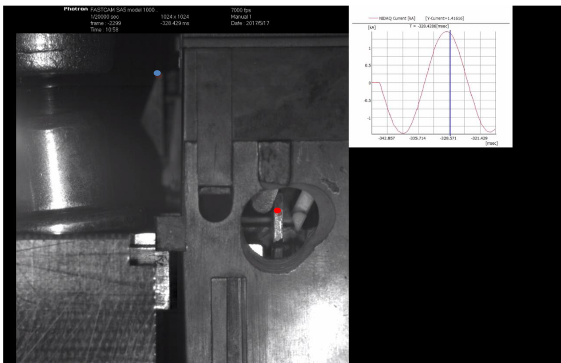
Obrázek 15: Snímek pořízený vysokorychlostní kamerou v okamžiku rozhodujícího dotyku kotvy s hřídelí – Standard 1500 A při nastavení MIN.
