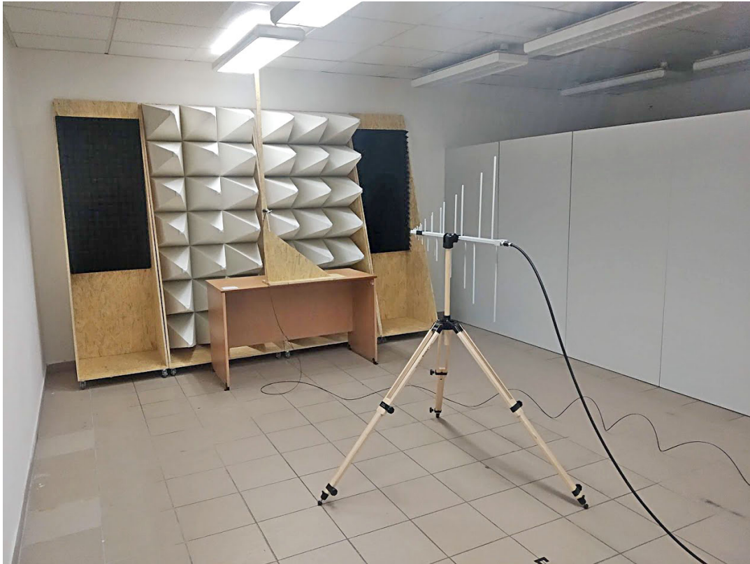
Obrázek 6.9: Měřicí konfigurace s log-periodickou anténou ve vertikální polarizaci (první konfigurace)
