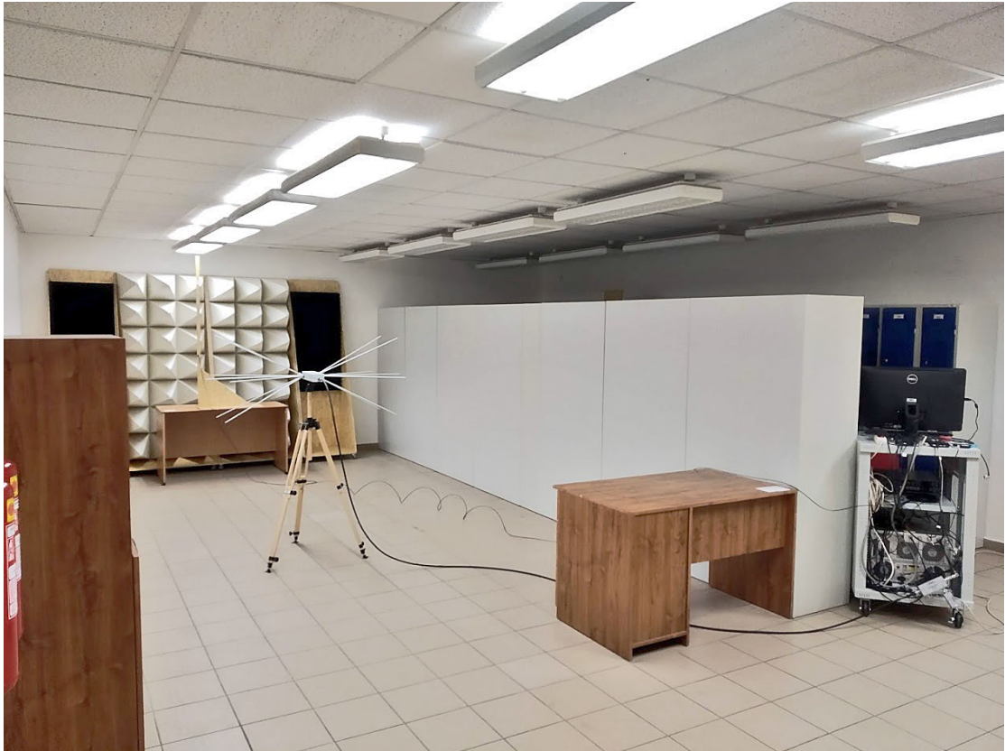
Obrázek 6.4: Úspěšná konfigurace pro měření s bikonickou anténou v horizontální polarizaci (šesté měření)
