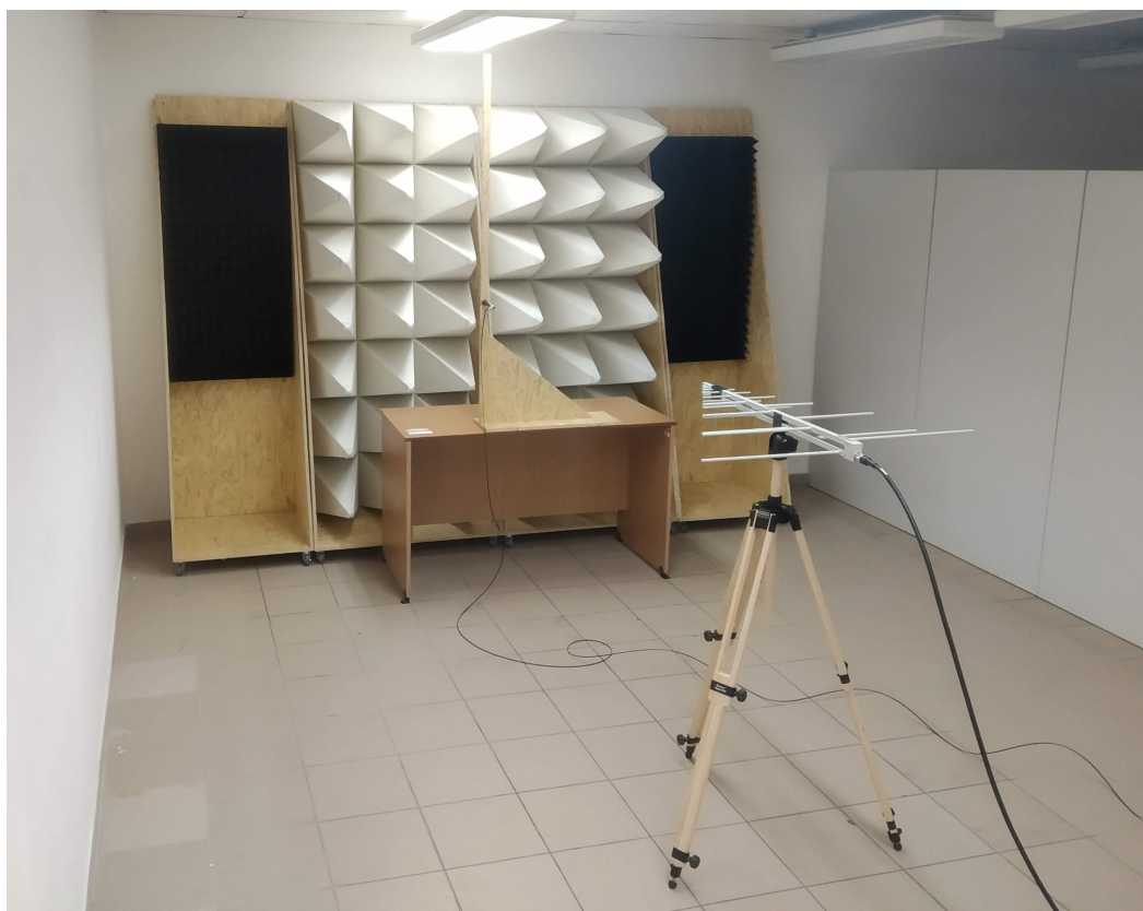
Obrázek 6.7: Konfigurace pro měření s log-periodickou anténou v horizontální polarizaci (čtvrté měření)
