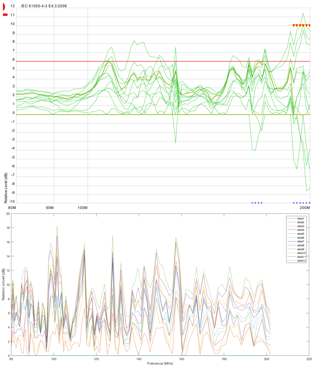
Obrázek 6.6: Srovnání grafů relativních odchylek měření a simulace pro 12 bodů, vertikální polarizaci BC 01
