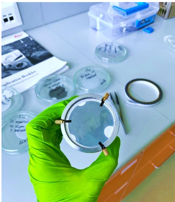
Obrázek 31: Připevnění filtru na držák vzorku (zdroj vlastní)
