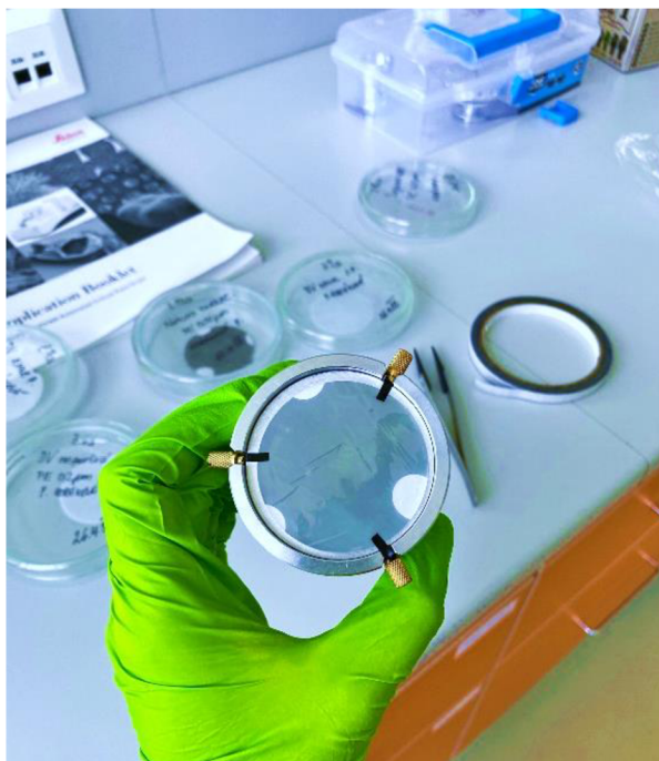
Obrázek 31: Připevnění filtru na držák vzorku (zdroj vlastní)
