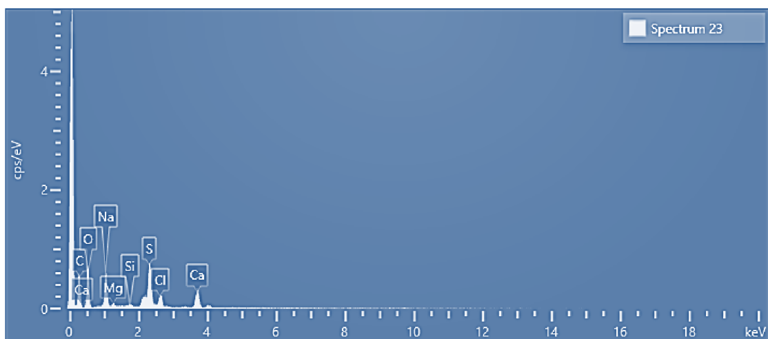
Obrázek 15: Prvkové spektrum - EDS analýza (zdroj vlastní)
