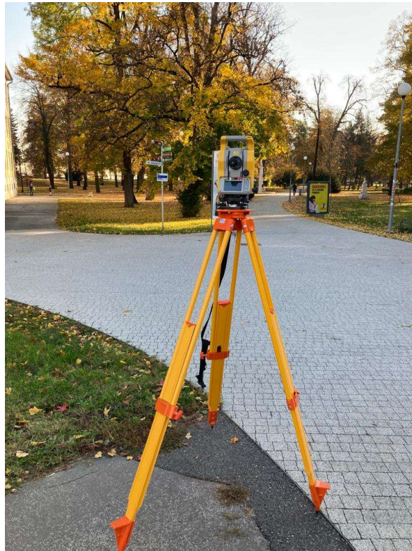
Obr. 4 Totálna stanica Trimble M3-DR2" (zdroj: autor)
